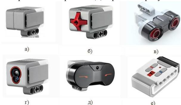
Рис. 1. Датчики для микрокомпьютера EV3: а) гироскопический датчик; б) датчик касания; в) ультразвуковой датчик; г) датчик цвета; д) инфракрасный датчик; е) инфракрасный маяк.
